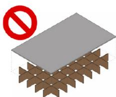
Elementos mixtos compuestos por **hormigón y cualquier otro material distinto del acero**
