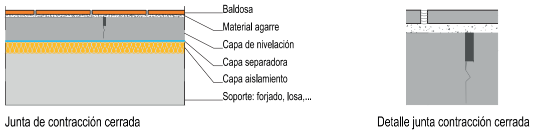
Figura 6.2-12.1-2 Junta de contracción cerrada.
